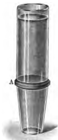
Fig. 87. — Dispositif pour l'essai de perméabilité des briques.
